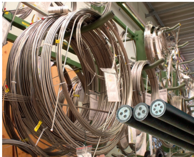
Cavo con isolamento minerale (cavo MI)
