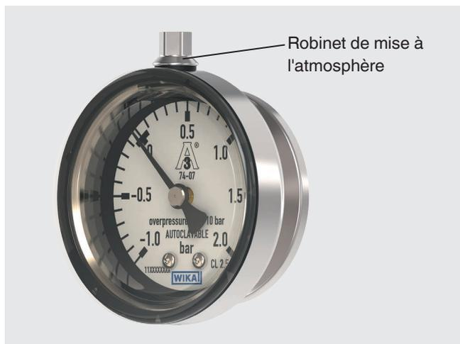
En ouvrant ou fermant le robinet de mise à l'atmosphère, on va mettre le boîtier à l'atmosphère ou l'isoler de l'atmosphère. Avant de lancer le processus d'autoclavage, assurez-vous que le robinet de mise à l'atmosphère a bien été fermé. Pour les dimensions voir page 11.
